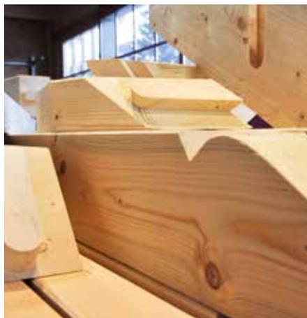
Diverse Holzverbindungen, gefertigt von der Abbundmaschine
